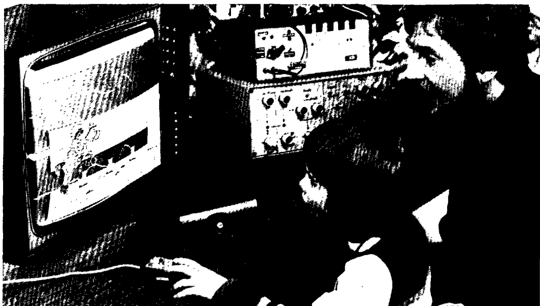
Para superar una deficiencia con respecto al lenguaje: el melógrafo, aparato experimental que permite formar imágenes con los sonidos. Se utiliza para reeducar niños sordos, y permite enseñar al niño a regular el volumen de su voz. CNET: Centre de Traitement de l'Ouïe et de la Parole, Fougères, Francia.
